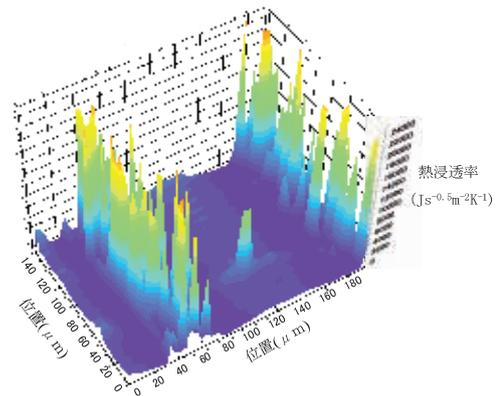
銅(Cu)中にニオブチタン(NbTi)の超伝導フィラメント(直径117μm)を埋め込んだ超伝導線材の断面の伝熱的性質の分布です。試料の繊維に平行な方向の面を研磨すると母材とフィラメントが帯状に交互に現われます。この図はこの面を測定したもので、熱を伝えやすい銅と、熱を伝えにくいニオブチタンの差が良く表れています。
