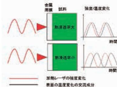
この図は熱物性顕微鏡の測定原理を示したものです。測定する試料の上に金属膜を付けます。この膜を周期的に強度を変えたレーザビームにより加熱し、その温度変化をもう一つのレーザの反射光の強度の変化から測定します。試料が熱を伝えやすいと、加熱の周期と温度の変化の周期は一致します。一方、熱を伝えにくい試料では2つの周期がずれます。このずれの量から試料の熱の伝わりやすさを求めます。
