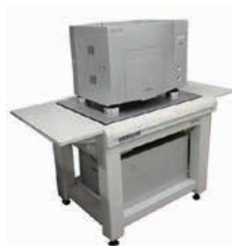
この図は最新の熱物性顕微鏡です。最初に開発された装置では10μm程度の空間分解能でしたが、開発により分解能を上げ、数μmの分解能が実現しました。
