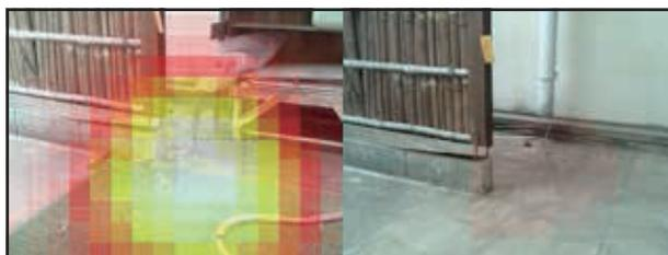
図2 住宅ビル屋上に生えたコケを中心に「ガンマアイ」で1時間測定した結果（左図）。赤が中間レベルで黄色、白の順番で線量が高い。右図はコケを除去後。
