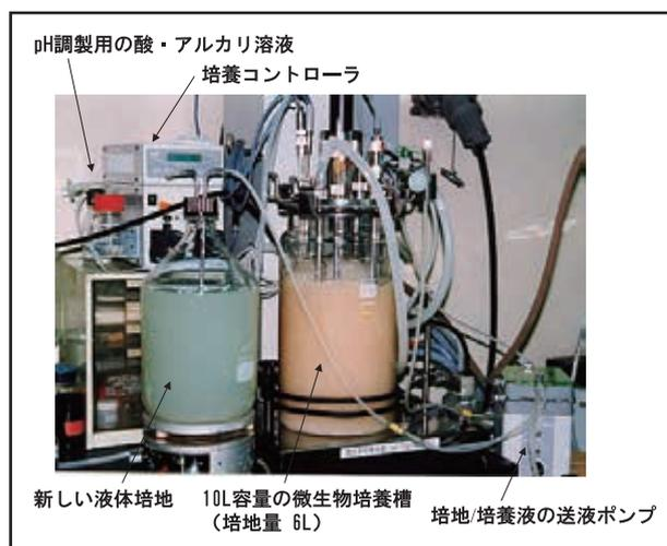
この図は、水素・酸素・炭酸ガスの混合ガスを培養基質として供給し、水素酸化細菌を培養しているところです。増殖速度に合わせて新しい培地を供給し、同じ流速で菌体培養液を培養槽から抜きとるといった連続培養の方法により、大量の菌体を得ることができます。グルコースポリマーであるグリコーゲンは酸素制限や窒素制限など、特別な培養条件にすることによって生産されます。
