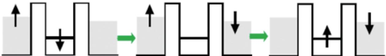
図2: 量子ドットと電極電子のスピンの相互作用
