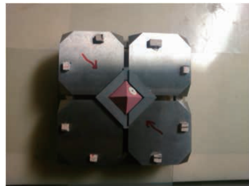
2段目のアンビルの中心部。真ん中の赤い8面体が圧媒体。試料はその八面体を貫く白い部分（マグネシア）に挿入する。
