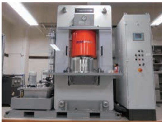
日本で初めて導入されたドイツ製高圧荷重装置。最大荷重1,000トン、加熱温度は2,000℃。達成圧力25GPaを目指す。
