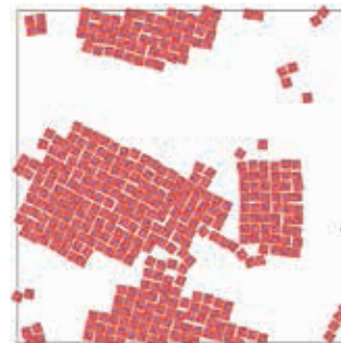
図1 粒子形状をキューブ状に制御した磁性ヘマタイト粒子の電子顕微鏡写真
