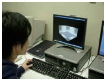
写真2 小型アンテナのコンピュータによる解析を行っているところ。電磁波解析ソフトを活用し効率的にアンテナ構造を決定していく。場合によっては計算時間が1日以上かかることもある。
