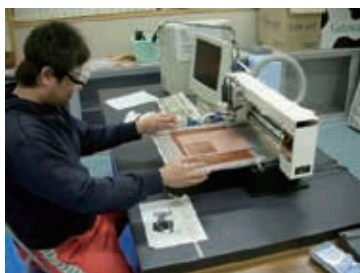
写真1 小型多周波共用アンテナ（パッチ構造）の実験のための試作アンテナを設計工作しているところ
