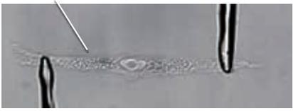
マイクロ引張試験装置による細胞の引張り強さの評価
